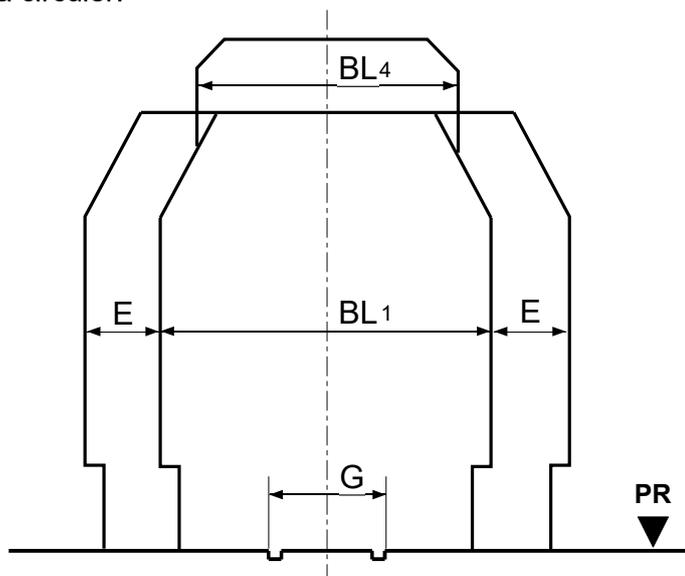
Pour l'élargissement nécessaire le déport latéral des véhicules est déterminant. Le déport latéral maximal à l'intérieur de la courbe le plus souvent provient des véhicules longs à bogies. La longueur de la caisse ou la distance effective entre les pivots du véhicule à bogies la plus longue est ainsi déterminante pour la valeur de la cote  $E$ .
